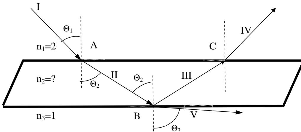
Ao emergir na lâmina no ponto C, [IV], a radiação irá surgir polarizada linearmente com o campo eléctrico apresentando-se perpendicular ao plano de incidência, dado que  $\theta_2$  é o ângulo de Brewster.
