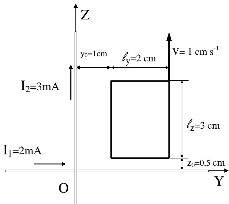
Ao longo do eixo dos  $YY$  encontra-se um **fio conductor** de secção recta de diâmetro  $D_y$  e comprimento  $\ell_y \gg D_y$ , percorrido por uma corrente estacionária  $I_1$ .
