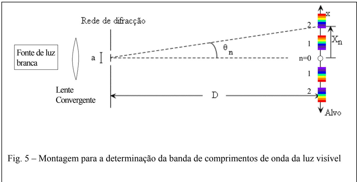
Fig. 5 – Montagem para a determinação da banda de comprimentos de onda da luz visível
