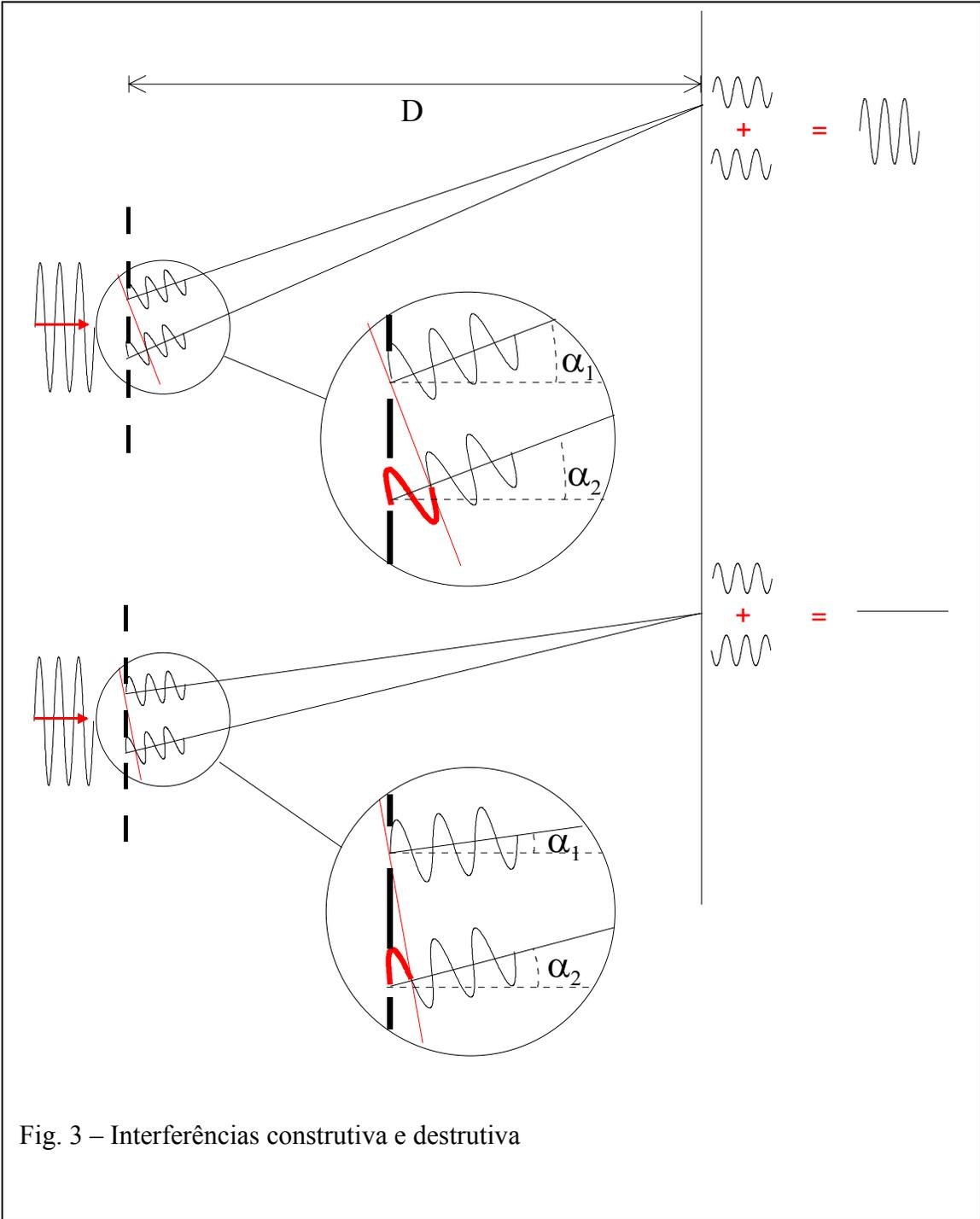
Fig. 3 – Interferências construtiva e destrutiva
