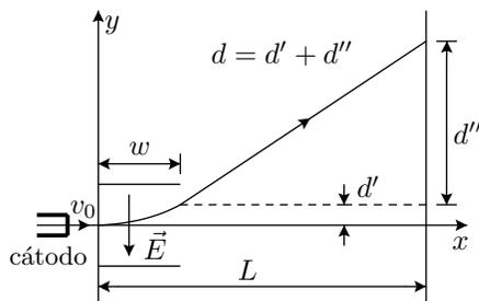
Os electrões saem do cátodo com uma velocidade  $v_0$  (paralela ao eixo  $x$ ), sofrendo depois uma deflexão pela acção do campo eléctrico  $E_d$  (paralelo ao eixo  $z$  e apontando para baixo), campo que actua ao longo do comprimento  $w$  das placas de deflexão. Calcular a deflexão total,  $d = d' + d''$ , sofrida pelos electrões ao embaterem no alvo situado em  $x = L$ .
