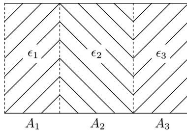
Calcule a distribuição  $\sigma_1, \sigma_2$  e  $\sigma_3$  das cargas sobre as placas do condensador, sabendo que os dielétricos são caracterizados pelas permissividades  $\epsilon_1 = \epsilon, \epsilon_2 = \epsilon_0$  e  $\epsilon_3 = \epsilon$ . Qual a capacidade do condensador e a energia electrostática quando as placas estão a uma diferença de potencial  $V$ ? Qual a relação entre os valores dos campos eléctricos nos três dielétricos? Onde se distribuem as cargas de
