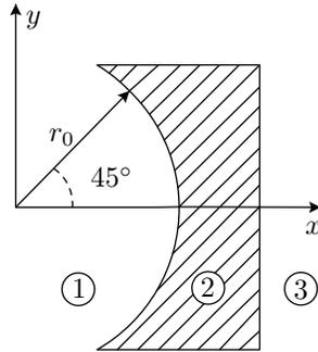
Se  $\vec{E}_1$ , no ponto indicado  $P(r_0, 45^\circ, z)$ , na região 1, for dado por  $\vec{E}_1 = 5\vec{e}_r - 3\vec{e}_\varphi$  (V/m), qual o valor que deverá ter a permissividade do dielétrico 2, para que o campo  $\vec{E}_3$ , na região 3, seja paralelo ao eixo  $x$ ?
