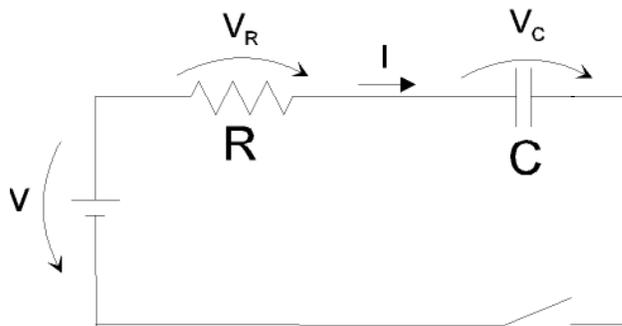
Figura 2: Circuito RC - Carga
