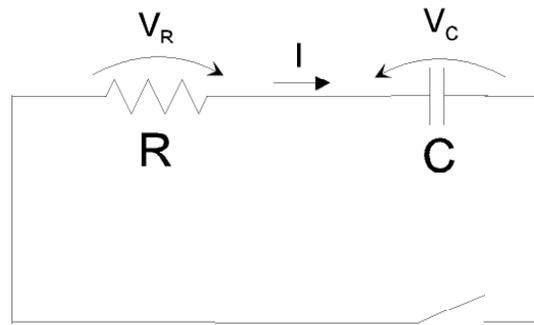
Figura 4: Circuito RC - Descarga
