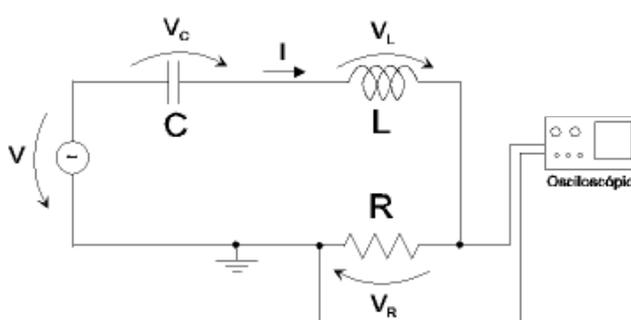
Figura 8: Montagem para medições no circuito RLC.
