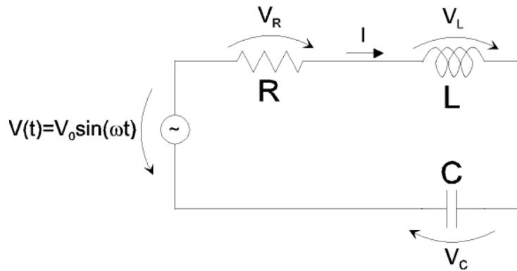
Figura 6: Circuito RLC série com fonte de tensão alternada sinusoidal.
