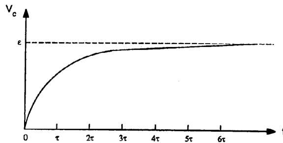
Figura 3 – Curva de carga de um condensador
