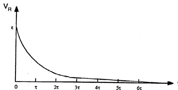
Figura 5: Curva de descarga de um condensador.
