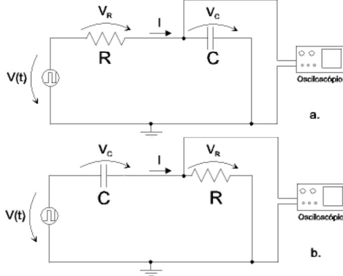
Figura 7: Medições no circuito RC. **a:**  $V_C$ ; **b:**  $V_R$  (I).
